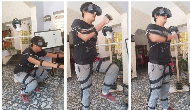
Fig. 16. Sujeto de pruebas realizando las acciones: agachado, correr y cambio de herramienta. Para el entrenamiento del algoritmo.
